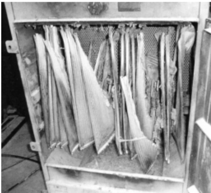
写真1 爆発したマグアル合金回収用の集じん機
